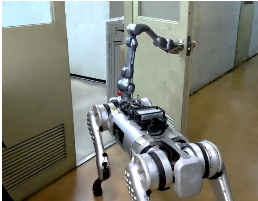
ドアの開閉を行う四足歩行ロボット
